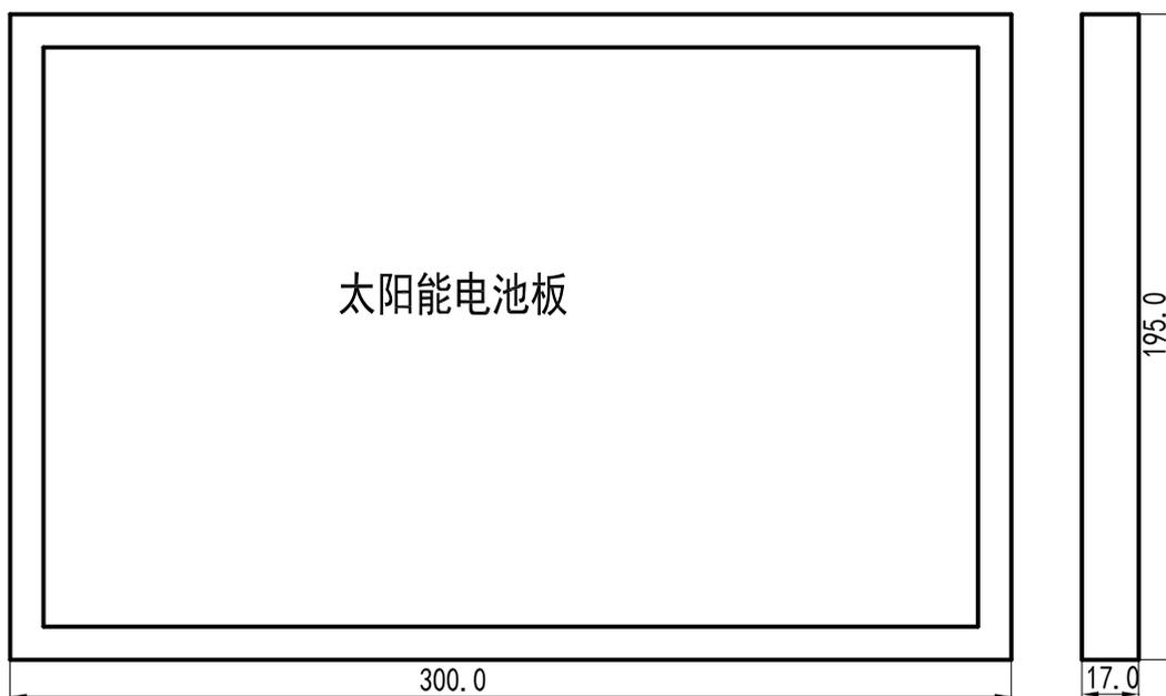
图 8 太阳能电池板安装尺寸
